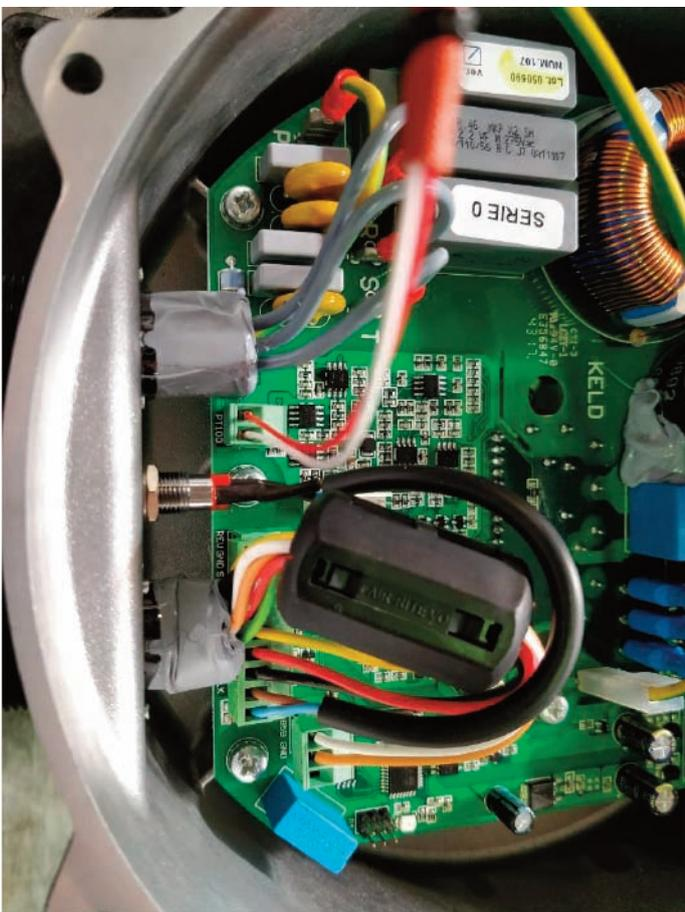
Insertar el conector verde, con cables Blanco/Rojo, del sensor de temperatura del motor en el correspondiente conector en la electrónica (colocado como se muestra en la imagen).
