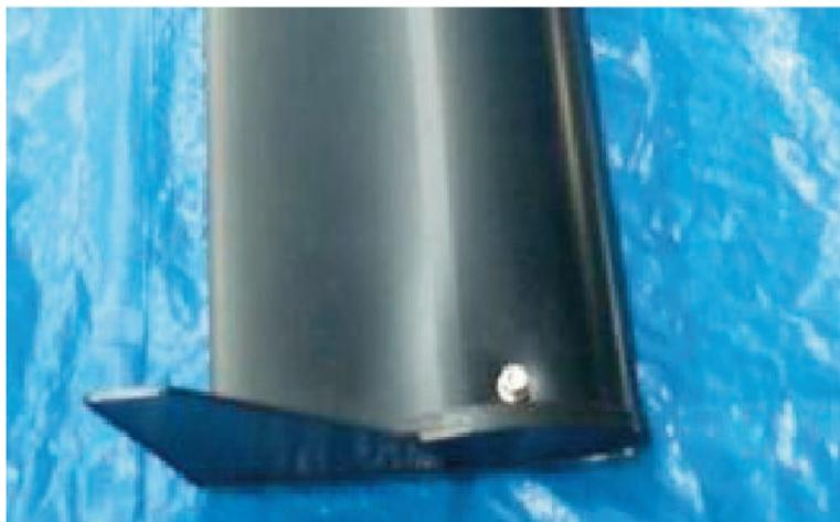
Desatornillar el tornillo que sujeta el Winglet de plástico a la pala.
